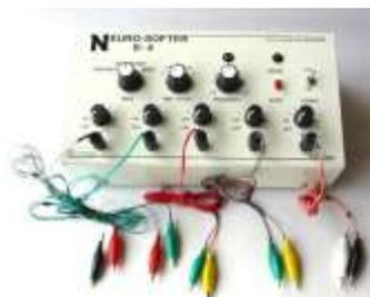
Electroestimulador de corriente alterna de baja frecuencia con cables individuales para sujetar cada aguja
